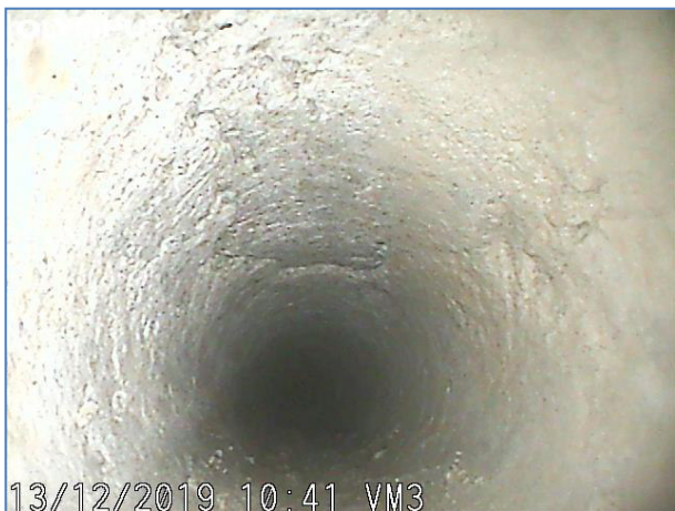
Immagine a 5 cm dall'inizio del foro. Elementi lapidei e malta.
