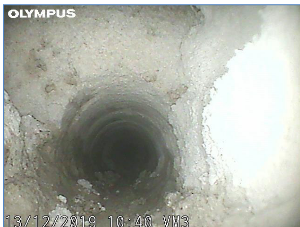
Immagine a 65 cm dall'inizio del foro. Elementi lapidei e malta.
