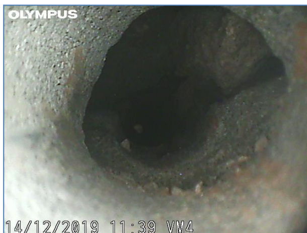
Immagine a 40 cm dall'inizio del foro. Muratura in mattoni.
