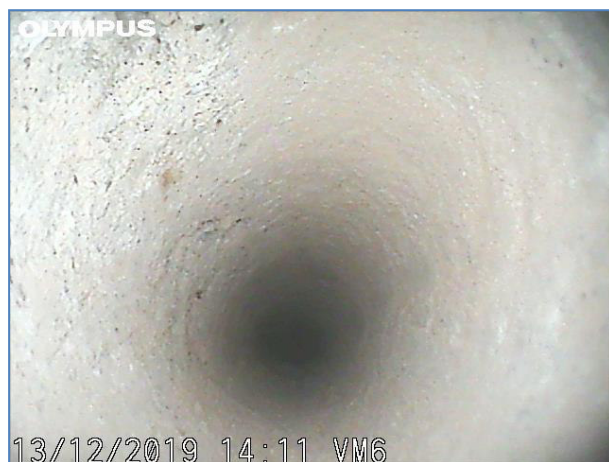
Immagine a 0 cm dall'inizio del foro. Intonaco e muratura mista.
