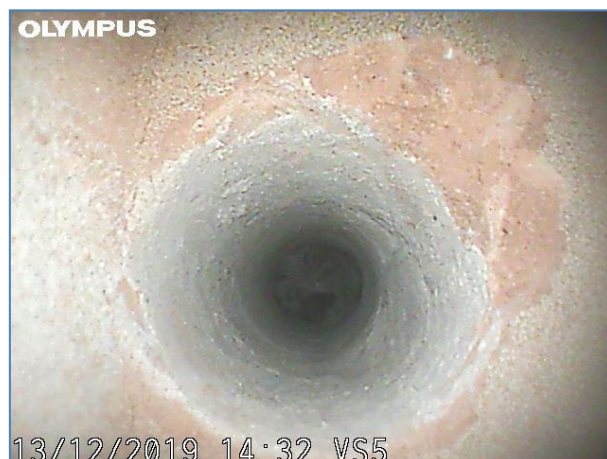
Immagine a 15 cm dall'inizio del foro. Elemento in laterizio.
