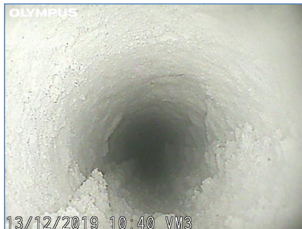
Immagine a 90 cm dall'inizio del foro. Elementi lapidei e malta.
