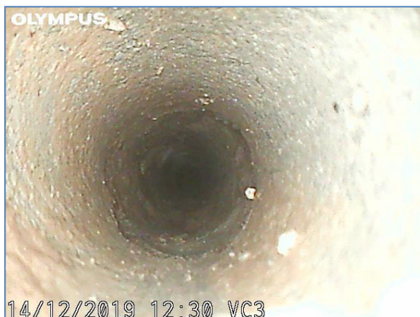
Immagine a 30 cm dall'inizio del foro. Cls compatto e muratura mista.
