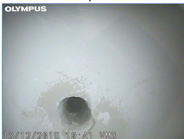
Immagine a 5 cm dall'inizio del foro. Elementi lapidei e malta.
