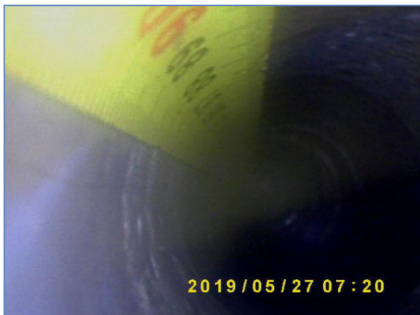
Immagine a 90 cm dalla fine del foro. Elementi lapidei e malta.
