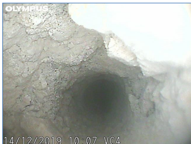
Immagine a 15 cm dall'inizio del foro. Cls compatto e muratura mista.
