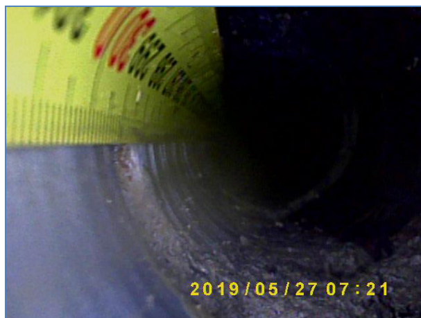
Immagine a 300 cm dalla fine del foro. Elementi lapidei e malta.
