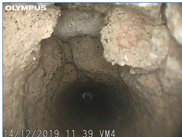
Immagine a 55 cm dall'inizio del foro. Muratura in mattoni.
