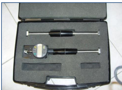
Deformometro e comparatore digitale millesimale
