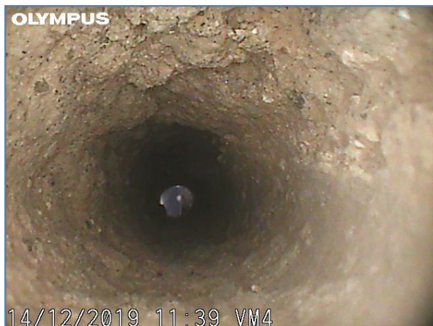
Immagine a 60 cm dall'inizio del foro. Muratura in mattoni.
