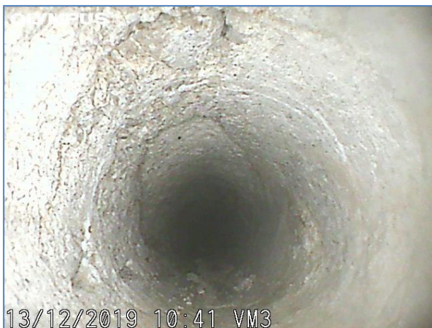
Immagine a 15 cm dall'inizio del foro. Elementi lapidei e malta.
