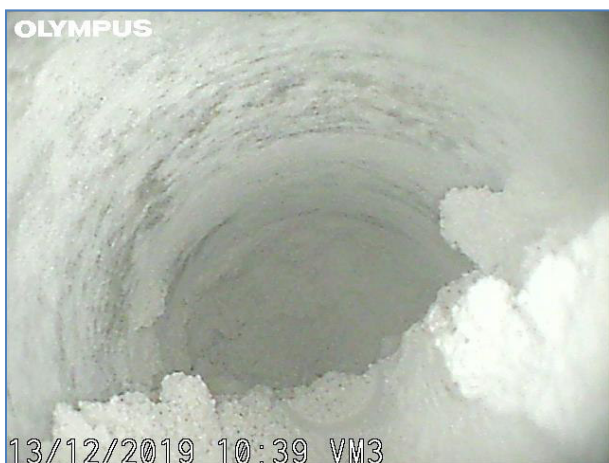
Immagine a 115 cm dall'inizio del foro. Elementi lapidei e malta.
