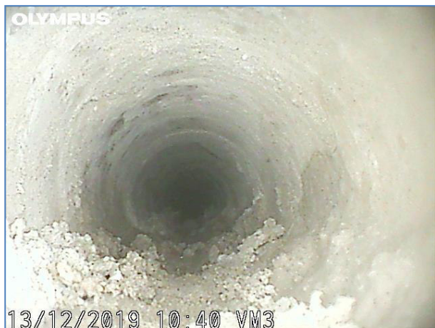
Immagine a 75 cm dall'inizio del foro. Elementi lapidei e malta.
