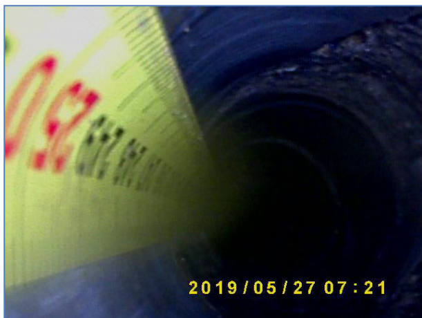
Immagine a 250 cm dalla fine del foro. Elementi lapidei e malta.
