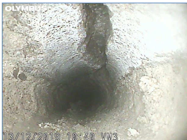
Immagine a 35 cm dall'inizio del foro. Elementi lapidei e malta.
