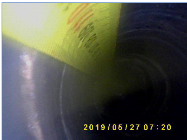
Immagine a 110 cm dalla fine del foro. Elementi lapidei e malta.
