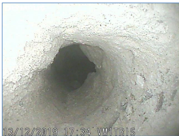
Immagine a 0 cm dall'inizio del foro. Intonaco e muratura mista.
