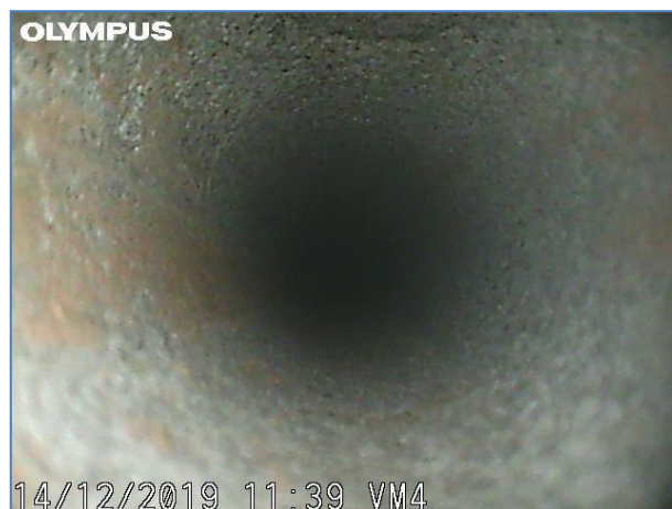
Immagine a 25 cm dall'inizio del foro. Muratura in mattoni.
