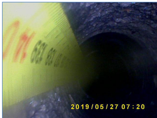
Immagine a 140 cm dalla fine del foro. Elementi lapidei e malta.
