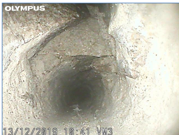
Immagine a 25 cm dall'inizio del foro. Elementi lapidei e malta.
