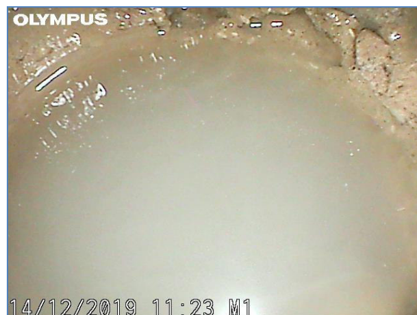
Immagine a 50 cm dalla fine del foro. Conglomerato a base di sabbia.
