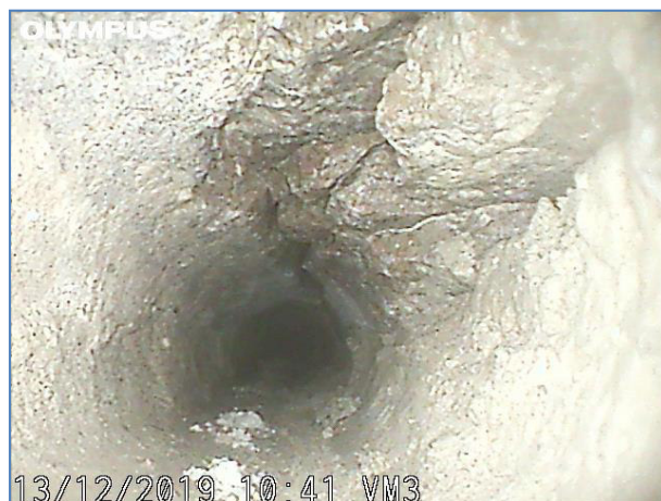
Immagine a 30 cm dall'inizio del foro. Elementi lapidei e malta.
