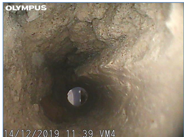
Immagine a 65 cm dall'inizio del foro. Muratura in mattoni.
