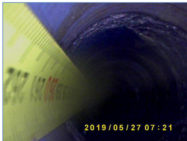
Immagine a 260 cm dalla fine del foro. Elementi lapidei e malta.
