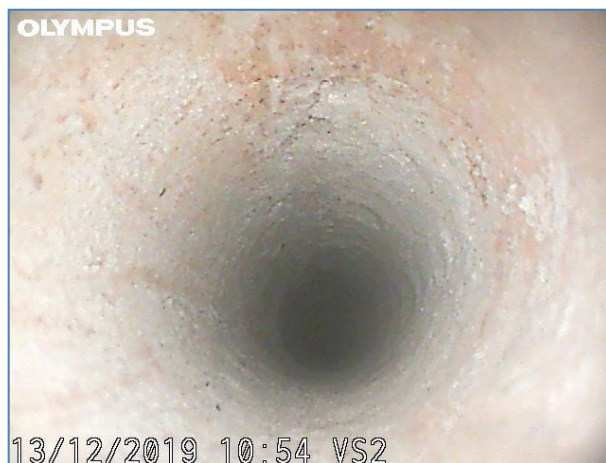
Immagine a 0 cm dall'inizio del foro. Pavimento e massetto.
