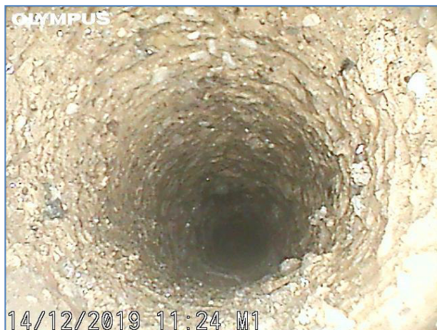
Immagine a 120 cm dalla fine del foro. Conglomerato a base di sabbia.
