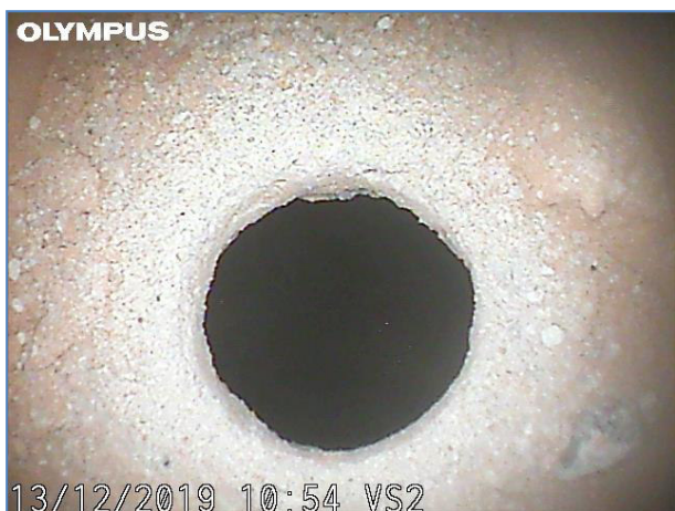
Immagine a 25 cm dall'inizio del foro. Elemento in laterizio.
