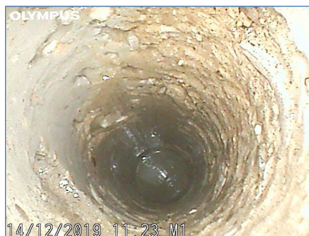
Immagine a 70 cm dalla fine del foro. Conglomerato a base di sabbia.
