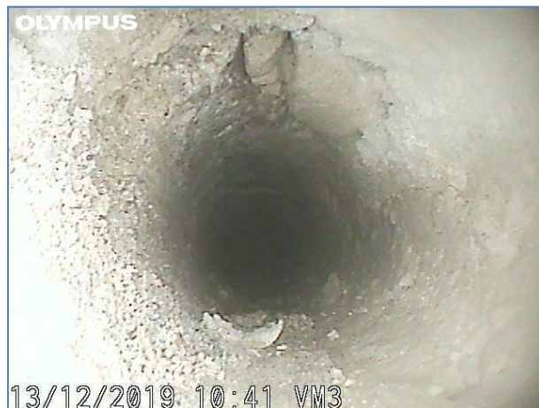
Immagine a 0 cm dall'inizio del foro. Elementi lapidei e malta.
