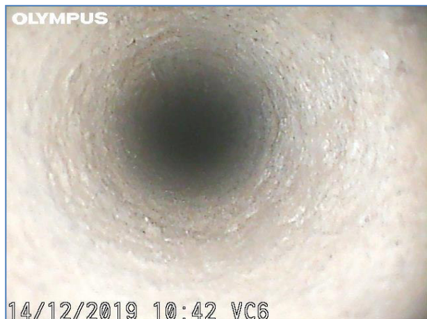
Immagine a 10 cm dall'inizio del foro. Muratura mista e cls compatto.
