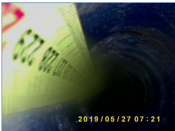
Immagine a 230 cm dalla fine del foro. Elementi lapidei e malta.
