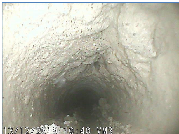
Immagine a 45 cm dall'inizio del foro. Elementi lapidei e malta.
