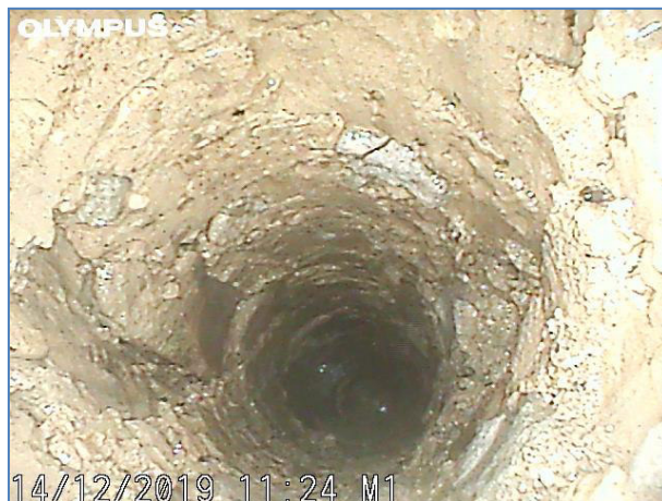
Immagine a 90 cm dalla fine del foro. Conglomerato a base di sabbia.
