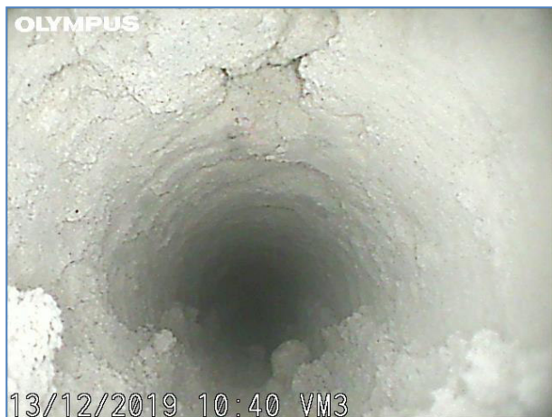
Immagine a 85 cm dall'inizio del foro. Elementi lapidei e malta.
