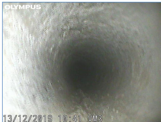
Immagine a 10 cm dall'inizio del foro. Elementi lapidei e malta.
