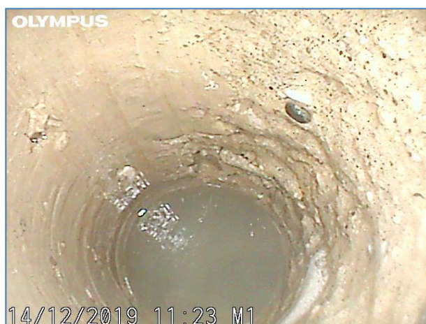
Immagine a 60 cm dalla fine del foro. Conglomerato a base di sabbia.
