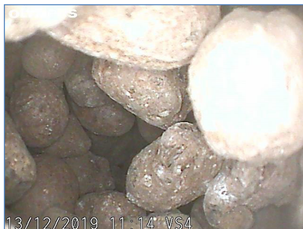
Immagine a 5 cm dall'inizio del foro. Argilla espansa.
