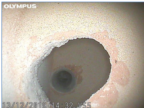
Immagine a 10 cm dall'inizio del foro. Elemento in laterizio e cls.
