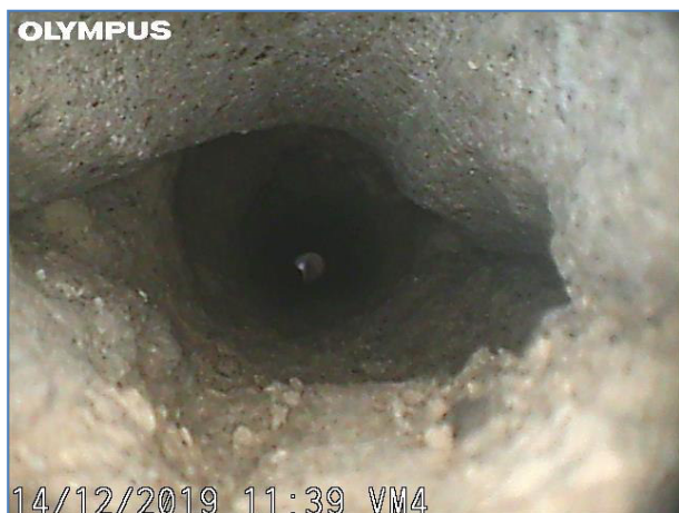
Immagine a 50 cm dall'inizio del foro. Muratura in mattoni.
