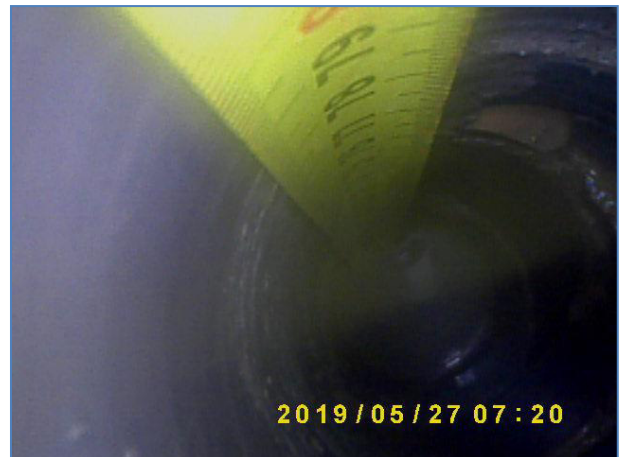
Immagine a 80 cm dalla fine del foro. Elementi lapidei e malta.
