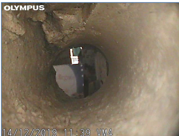
Immagine a 70 cm dall'inizio del foro. Muratura in mattoni.
