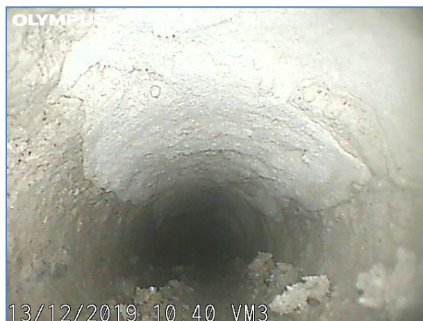
Immagine a 50 cm dall'inizio del foro. Elementi lapidei e malta.
