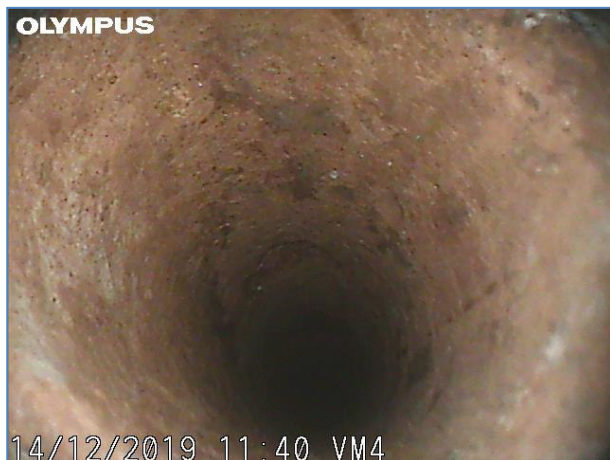
Immagine a 0 cm dall'inizio del foro. Muratura in mattoni.
