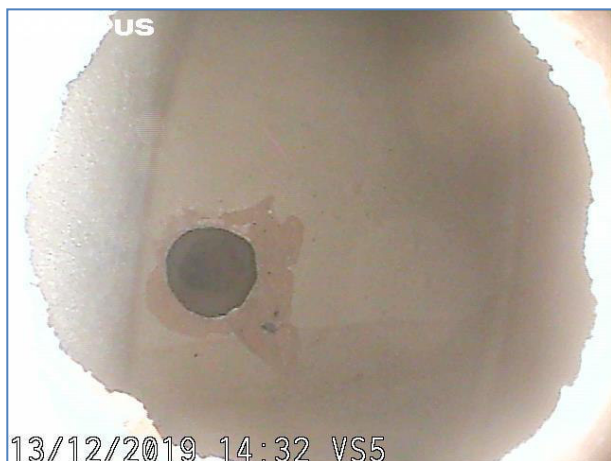
Immagine a 10 cm dall'inizio del foro. Elemento in laterizio e cls.
