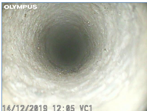
Immagine a 20 cm dall'inizio del foro. Muratura mista e cls compatto.
