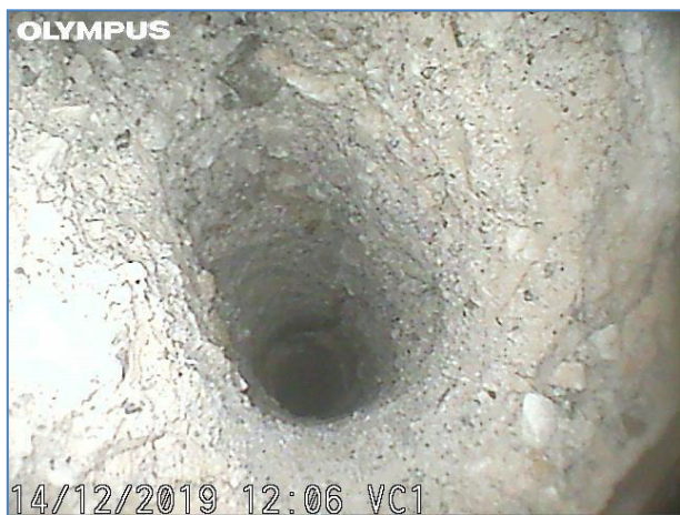
Immagine a 0 cm dall'inizio del foro. Intonaco.
