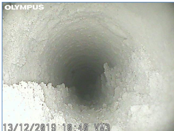
Immagine a 95 cm dall'inizio del foro. Elementi lapidei e malta.
