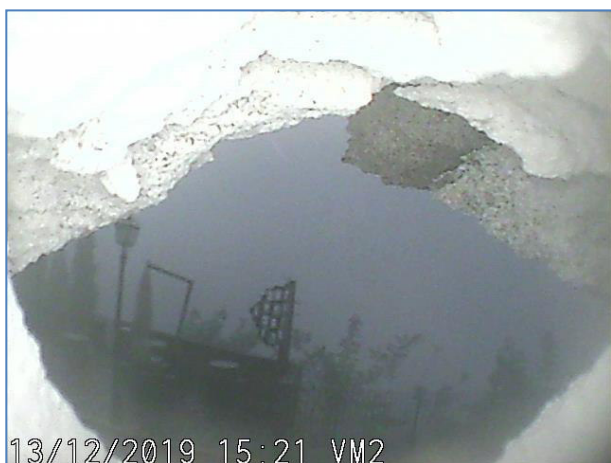
Immagine a 70 cm dall'inizio del foro. Intonaco.
