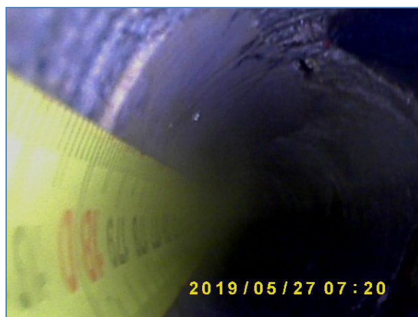
Immagine a 180 cm dalla fine del foro. Elementi lapidei e malta.
