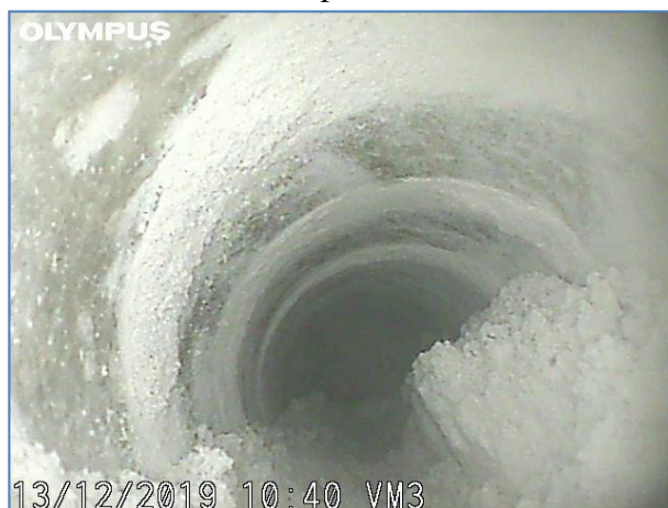
Immagine a 110 cm dall'inizio del foro. Elementi lapidei e malta.
