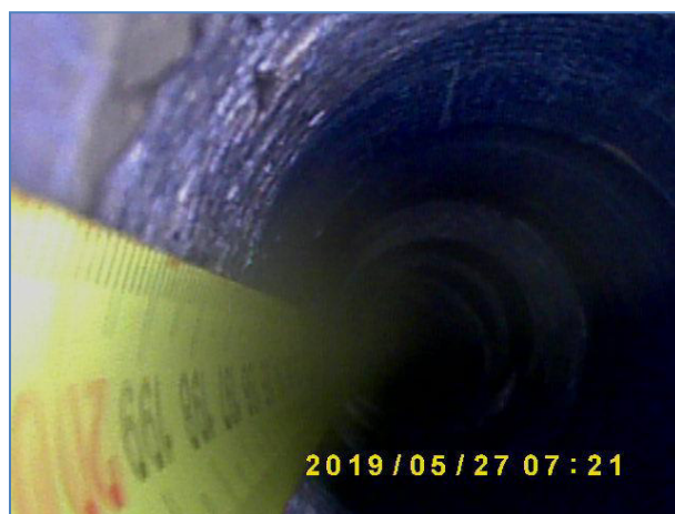
Immagine a 200 cm dalla fine del foro. Elementi lapidei e malta.
