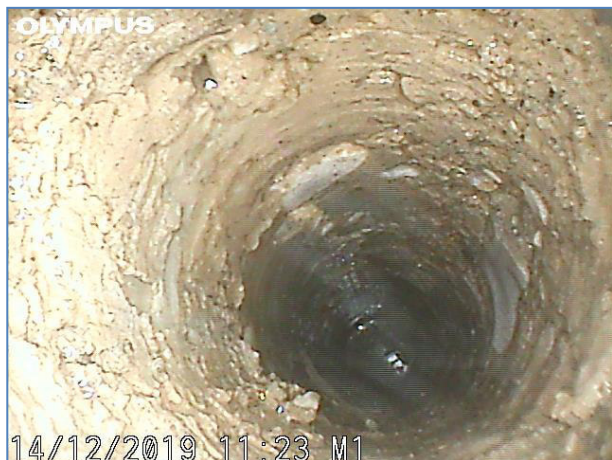
Immagine a 80 cm dalla fine del foro. Conglomerato a base di sabbia.
