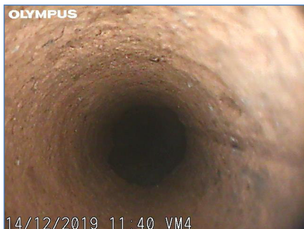
Immagine a 10 cm dall'inizio del foro. Muratura in mattoni.
