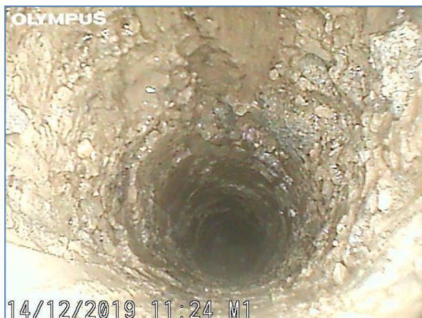
Immagine a 100 cm dalla fine del foro. Conglomerato a base di sabbia.
