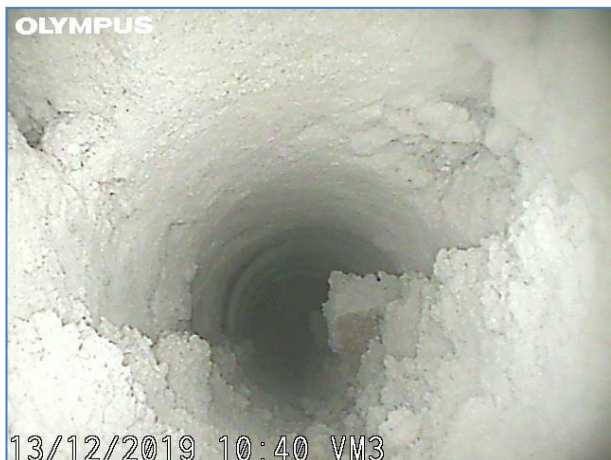
Immagine a 105 cm dall'inizio del foro. Elementi lapidei e malta.
