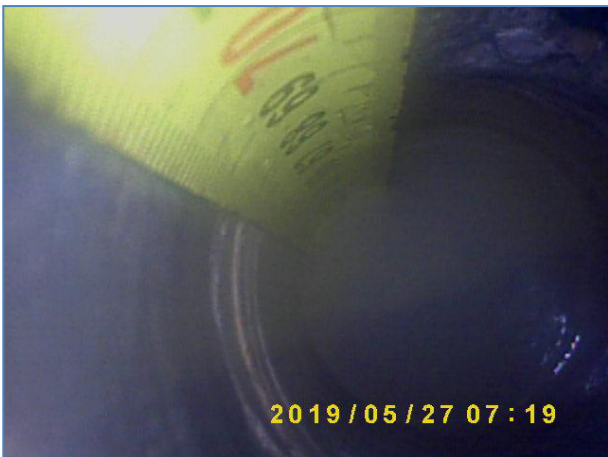
Immagine a 70 cm dalla fine del foro. Elementi lapidei e malta.
