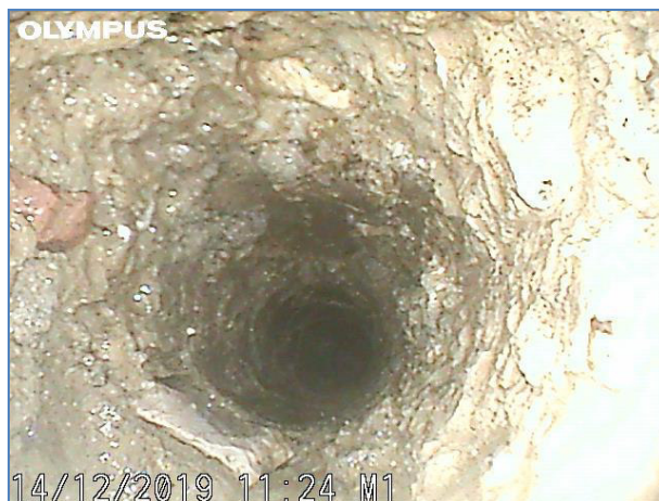
Immagine a 110 cm dalla fine del foro. Conglomerato a base di sabbia.
