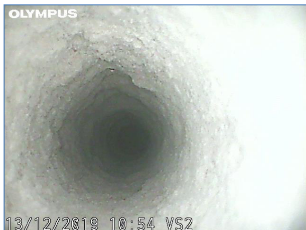
Immagine a 5 cm dall'inizio del foro. Massetto.
