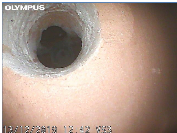
Immagine a 5 cm dall'inizio del foro. Elemento in laterizio e cls.
