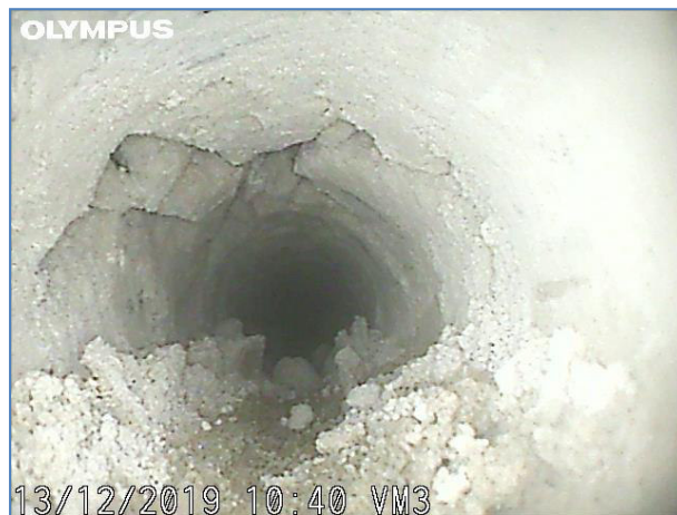
Immagine a 80 cm dall'inizio del foro. Elementi lapidei e malta.
