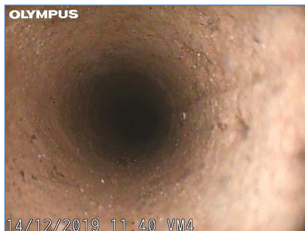
Immagine a 5 cm dall'inizio del foro. Muratura in mattoni.
