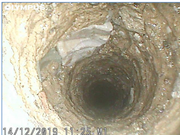
Immagine a 140 cm dalla fine del foro. Conglomerato a base di sabbia.
