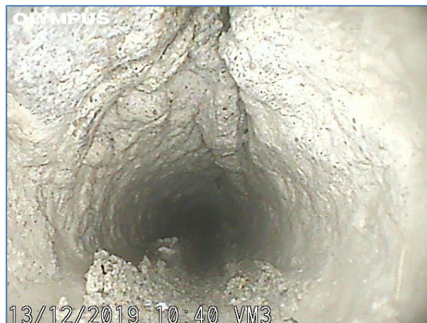
Immagine a 40 cm dall'inizio del foro. Elementi lapidei e malta.
