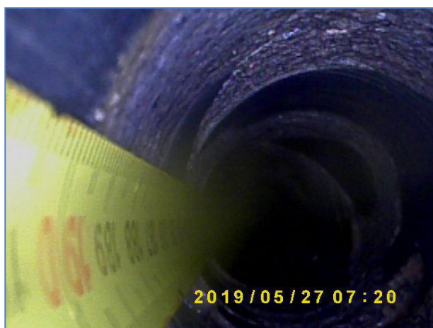
Immagine a 190 cm dalla fine del foro. Elementi lapidei e malta.
